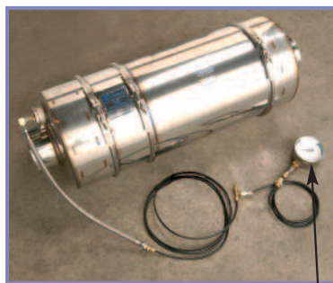
Manuell verkstads-manometer med slangar och skruvkoppling
